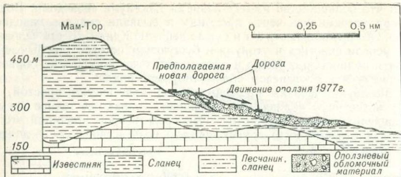
Оползень Мам-Тор, в результате которого зимой 1977 г. была сильно разрушена дорога, проходящая поперек оползня.
