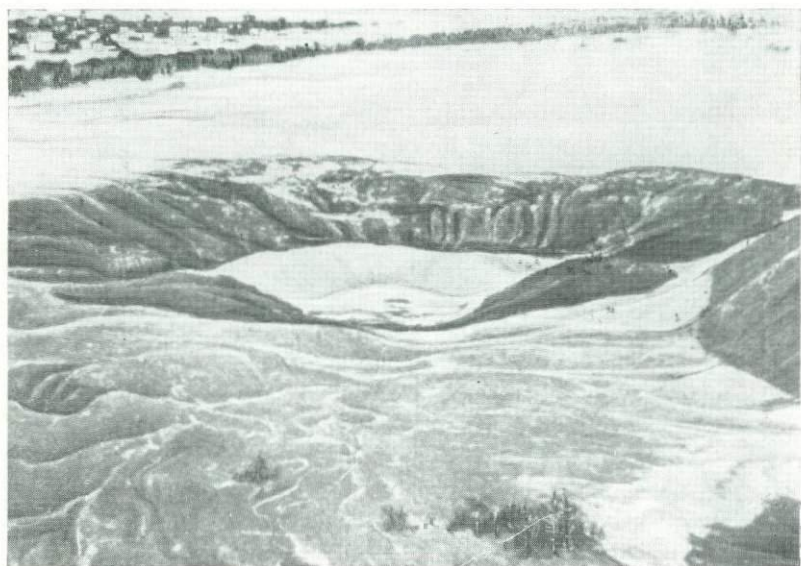
Карстовая воронка диаметром около 275 м, образовавшаяся в 1970 г. над шахтой Муфулира (Замбия).
