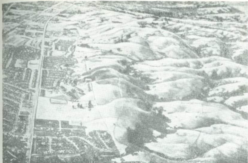
Справа от шоссе, почти параллельно ему видна линия разлома Сан-Андреас. Жилые массивы, располагающиеся между дорогой и холмами, находятся на зоне разлома.
