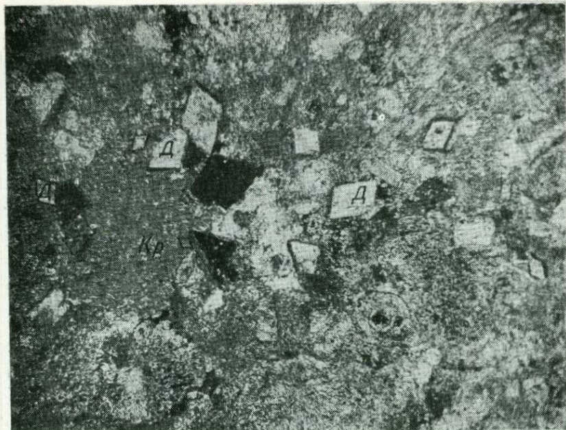
Рис. 2. Коррозия кристаллами доломита (д) обломка криноидеи (кр). Криноидно-мшанковый известняк. Датский ярус. Карьер «Южный-П». Шлиф. \times 50 . Ник. +.
