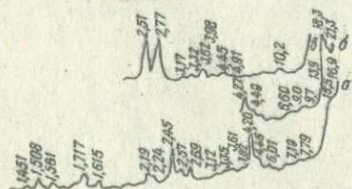
Рис. 3. Дифрактометрические кривые фракции менее 1 мк цемента переходной руды обр. 105: а - исходный образец; б - насыщенный глицерином; в - прокаленный при температуре 550^{\circ}\text{C} .
