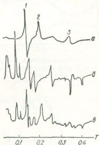
Рис. 27. Вид спектра ЭПР \text{Fe}^{3+} в порошках низкотемпературных щелочных полевых шпатов: а — микроклин; б — альбит; в — пертит.
