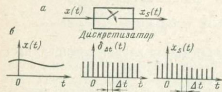
Рис. 1.2. Преобразование непрерывного сигнала в дискретный.
