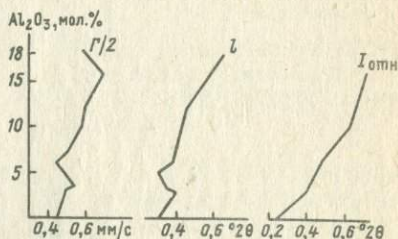
Рис. 26. Зависимость величины полуширины полос на мессбауэровских спектрах ( \Gamma/2 ), а также ширины ( l ) и относительной интенсивности ( I_{отн} ) отражения (104) на дифрактограммах от степени замещения Fe^{3+} - Al^{3+} в гематите
