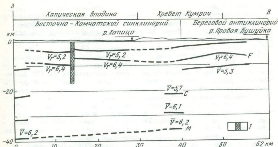
Рис. 17. Разрез ГСЗ по профилю Халиченская впадина – р. Правая Бушуйка F – подошва фундамента, C – кровля базальтового слоя, M – граница Мохоровичича; 1 – разрывное нарушение; пояснение V см. на рис. 14
