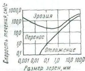
Рис. 6. Зависимость состояния частиц и осадка от скорости течения (по Хьюльстрему, 1939 г.)
