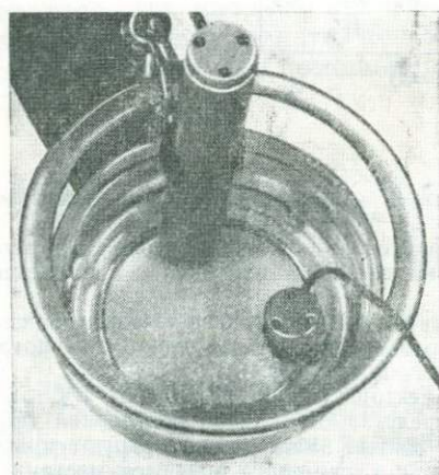
РИС. 9.3. Выполнение принципа взаимности для упругих колебаний, возбуждаемых электромагнитной системой [32]
