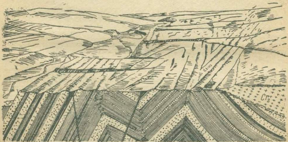
Рис. 58. Вид с птичьего полета на северо-западную часть Первозвановского плашета (Донецкий бассейн); передняя стенка — меридиональный геологический разрез (см. рис. 59).
