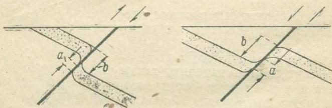
Рис. 31. Завороты пластов при сбросах в разрезе; a — видимая амплитуда передвижения, b — истинная.
