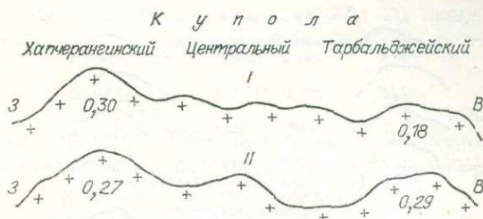
Рис. 2. Продольный разрез гранитов по геофизическим данным. В интерпретации Ю. Н. Бугрова, Г. И. Менакера (I) и В. Д. Огородникова (II). Цифры — отношение высоты купола к его основанию.
