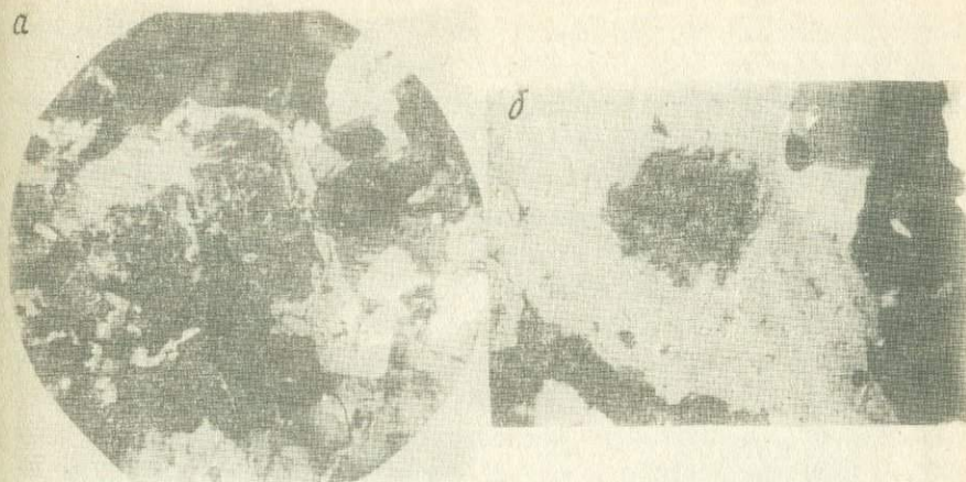
Фото 3. Структуры замещения калиевого полевого шпата альбитом. С анализатором.
