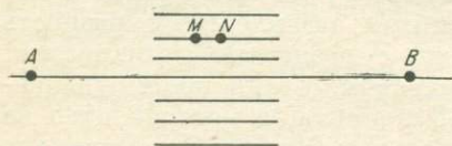
Рис. 26. Установка с вынесенными измерительными заземлениями.
