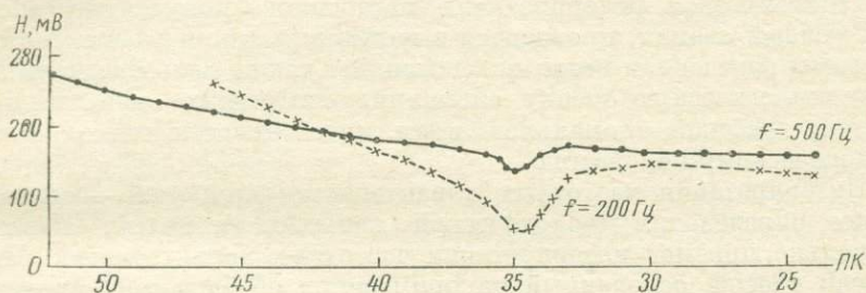
Рис. 202. Графики амплитуды вертикальной составляющей магнитного поля петли (геологический разрез составлен по результатам геофизических и буровых работ).
