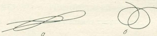
Рис. 176. Поляризация векторов магнитотеллурического поля. а — линейная; б — нелинейная.
