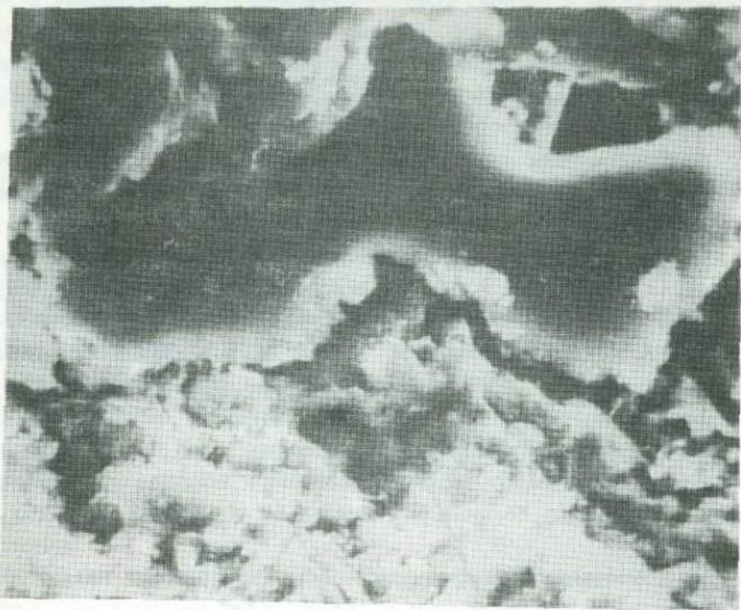
Рис. 23. Песчаник мелкозернистый кварцевый с хлоритовым цементом Площадь Советская, скв. 6, интервал 4265—4270 м, увел. 1000 (РЭМ), K_1h
