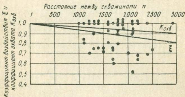
Рис. 44. Зависимость коэффициентов воздействия и охвата от расстояния между скважинами по пласту Д 1 Пономаревского месторождения [101].
