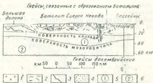
Рис. 2. Разрез через батолит Сьерра-Невада 1— гранитоиды; 2— метаморфические породы; 3— разломы; 4 — верхнемеловые и кайнозойские осадочные породы.
