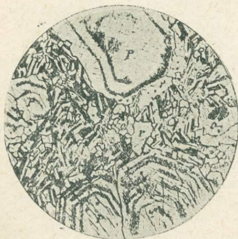
Фиг. 28. Габбро-порфирит. P — пироксен, O — оливин, F — плагиоклаз. Основная масса мелкозернистая. \times 12 .
