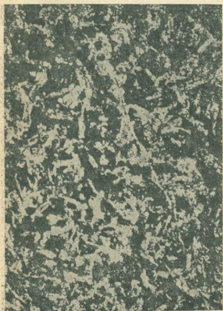
Фиг. 33. Измененный диабаз. Структура слегка порфировидная; видны порфировые выделения моноклинного пироксена. Полевой шпат (белые участки) нацело замещен весьма тонкозернистым агрегатом минерала из группы эпидота (?) (доизит-клинодоизит). Темные участки на снимке представляют собою остатки пироксена, зерна эпидота, пластинки хлорита и лейкоксен. Без анализатора. \times 20
