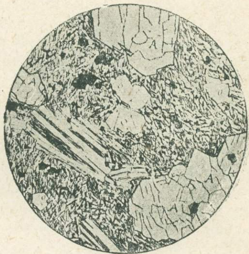
Фиг. 29. Оливиновый лампрофир. О — оливин, А — авгит, черное — магнетит. В основной массе плагиоклаз с зернами авгита и магнетита. \times 18 .
