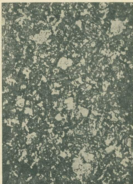
Фиг. 34. Хлорито-гранато-везувиановая порода. Сохранилась диабазовая структура первичной породы. Столбчатые участки (темные на снимке), состоящие главным образом из граната, по видимому являются псевдоморфозами по полевому шпату первичной породы, пироксен которой замещен хлоритом, занимающим пространства между названными участками. Без анализатора. \times 30 .
