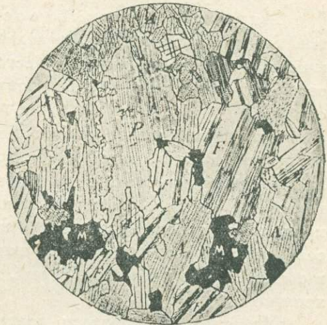
Фиг. 14. Габбро роговообманковое. P — пироксен, A — роговая обманка, F — плагиоклаз, M — магнетит. \times 20 .
