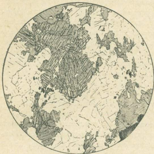
Фиг. 12. Габбро-амфиболит типа Круглой горы. Плагиоклаз и зеленая роговая обманка, зерна которых срastaются группами. \times 16 .
