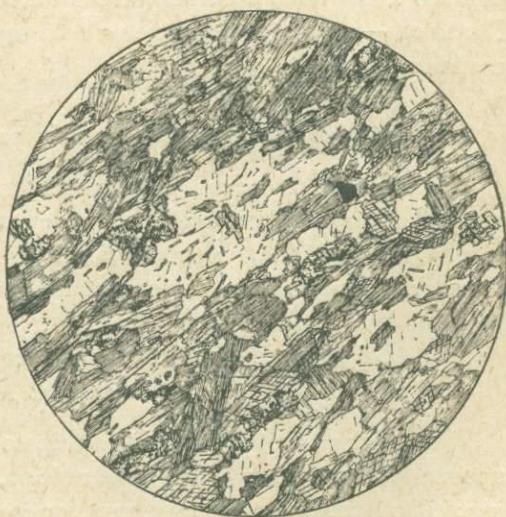
Фиг. 15. Сланцеватый габбро-амфиболит; кроме плагиоклаза и роговой обманки скопление цоизитовой мути (точки), зерна магнетита. \times 16 .
