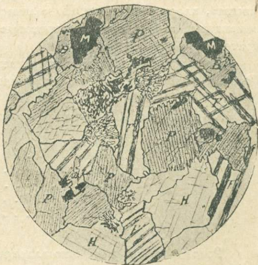
Фиг. 13. — Норит микрогематитовый. P — диопсид, H — гиперстен, F — плагиоклаз, M — магнетит, B — биотит. Микрогематитовое прорастание гиперстена и плагиоклаза, а также гиперстена и магнетита. \times 22 .
