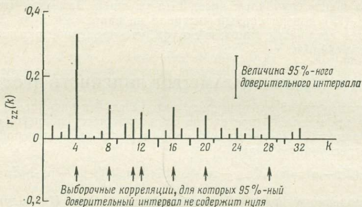
Рис. 5.14. Выборочная корреляционная функция для выборки, образованной случайными нормальными числами, r_{xx}(0) = 1 .
