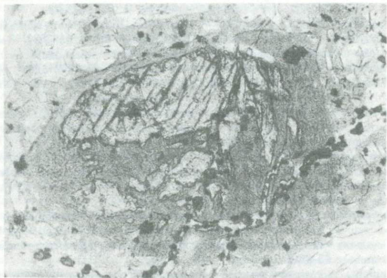
Рис. 3. Замещение титан-авгита хлоритом (серое) и скопление мелких сферолитов сфена в тончайших прожилках ломончита. Увел. 70, без анализатора
