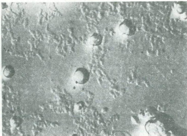
Рис. 26. Характер частиц в золе кремнезема. Обволакивающая угольная реплика. Увел, 40 000
