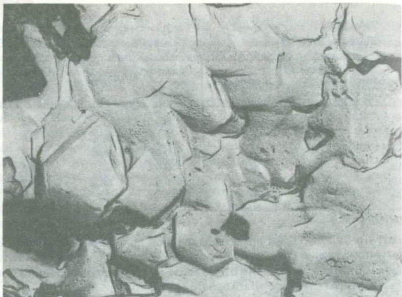
Рис. 55. Корродированные ромбоэдрические кристаллы киновари из плотных землистых образований. Целлюлозно-угольная реплика. Увел. 12 000
