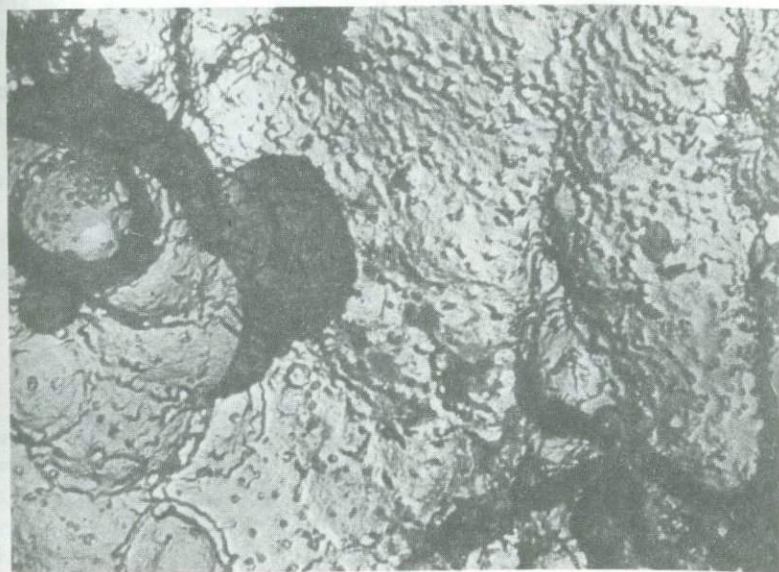
Рис. 29. Распределение воды в приповерхностных участках порчкового геля кремнезема. Обволакивающая угольная реплика. Увел. 36 000
