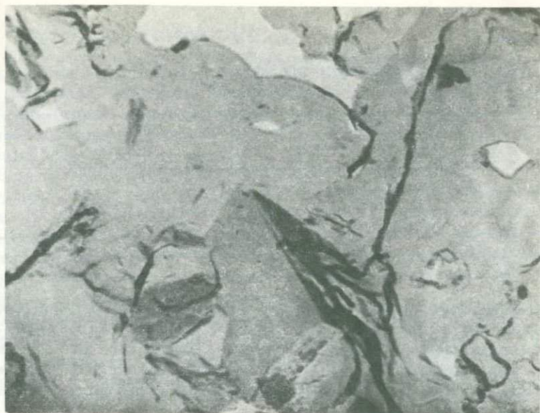
Рис. 46. Кристалл реальгара в пористой массе новообразованного опала. Целлюлозно-угольная реплика. Увел. 6000
