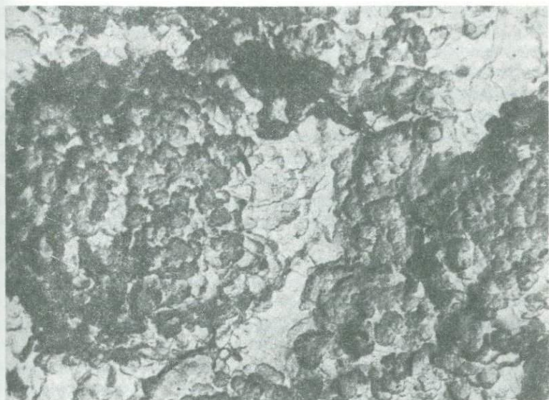
Рис. 31. Участок хризоколлы сферолитового строения. Обволакивающая угольная реплика. Увел. 36 000
