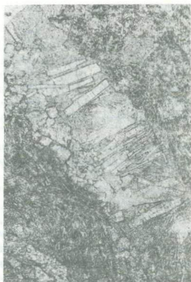
Рис. 16. Участки собирательной перекристаллизации в тонкозернистом ангидрите. Проходящий свет. Увел. 90, с анализатором
