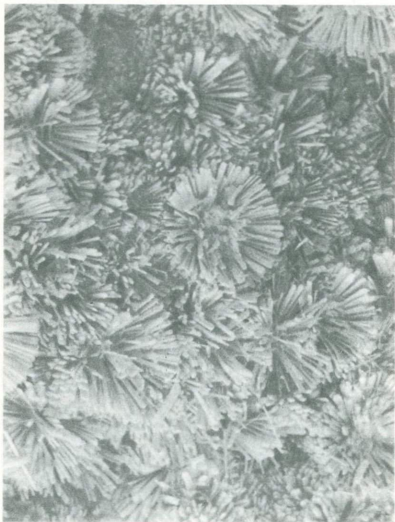
Строение войлокообразных агрегатов антимонита под растровым электронным микроскопом — рыхлый агрегат сферолитов антимонита; увел. 300
