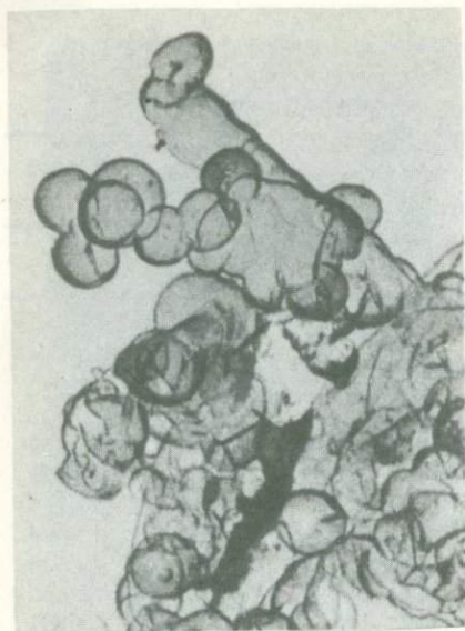
Рис. 44. Скопление глобуль и обломок мембранной трубки порошкового геля кремнезема. Обволакивающая угольная реплика. Увел. 22 000
