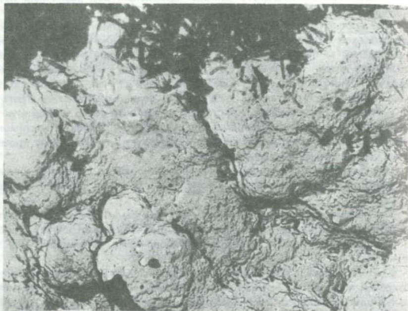
Рис. 52. Микропочковидные агрегаты метастибнита с кристаллами антимонита на поверхности (нерастворившиеся игольчатые частицы черного цвета). Целлюлозно-угольная реплика. Увел. 12 000
