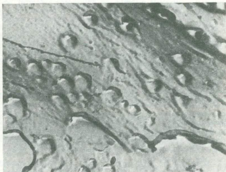
Рис. 47. Распределение включений пирита в темно-сером опале. Целлюлозно-угольная реплика. Увел. 10 000
