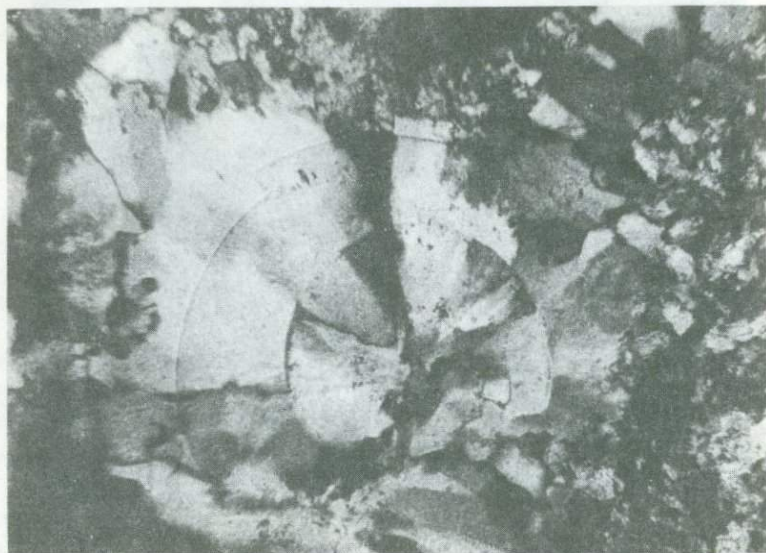
Рис. 8. Реликты концентрически-зонального строения агрегатов зернистого кварца в центральных частях прожилка. Проходящий свет. Увел. 90, с анализатором
