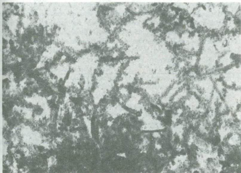
Рис. 39. Губчатые агрегаты глобуль коллоидного сульфида мышьяка ( As_2S_3 ) метареального. Угольная реплика. Увел. 20 000
