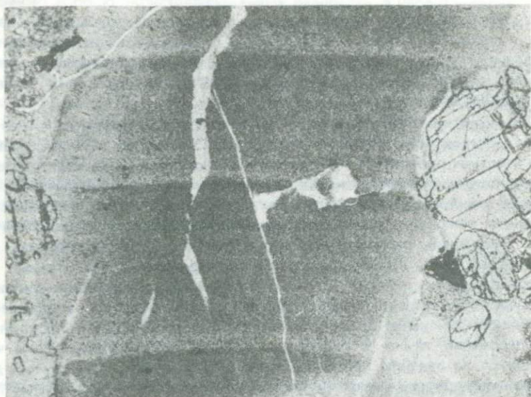
Рис. 21. Диффузионное распределение гематитового пигмента в метаколлоидном помоните. Проходящий свет. Увел. 46, без анализатора
