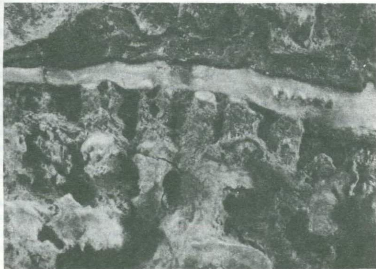
Рис. 51. Строение гейзеритовой коры из нависающего козырька оз. Охаки-Пул в поперечном разрезе. Темная зона, расположенная над белой полосой, обогащена рудными компонентами. Косой свет. Увел. 5.
