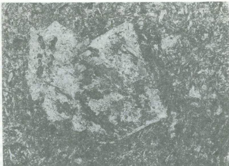
Рис. 5. Замещение плагиоклаза кальцитом. Увел. 45, без анализатора
