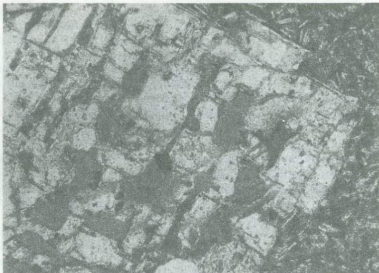
Рис. 4. Замещение плагиоклаза хлоритом (серое). Увел. 90, с анализатором
