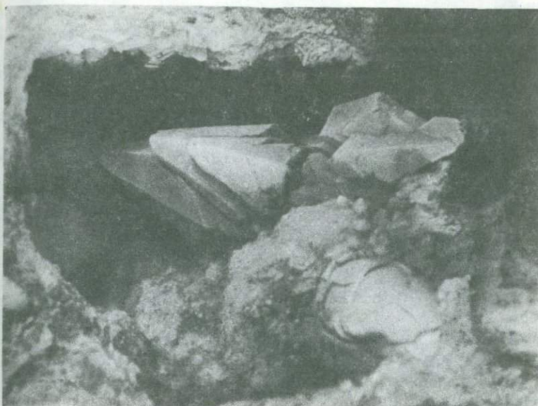
Рис. 13. Кальцит скаленоэдрического облика в ассоциации с кварцем I генерации и халцедоном. Косой свет. Увел. 10 (интервал глубин 483—486)
