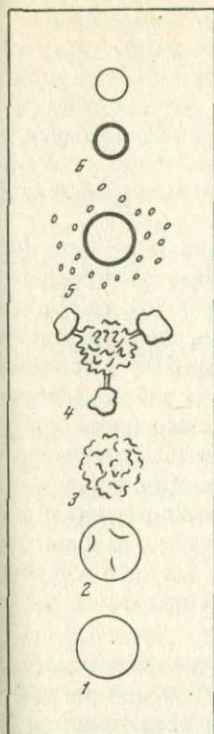
Рис. 36. Схематическое представление разрушения частиц в плазме и струйного выброса паров
