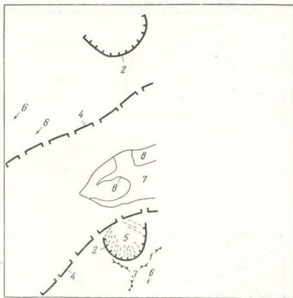
Фиг. 4. Денудационно-тектонические горы (альпинотипный рельеф) на вулканогенном субстрате раннечетвертичного возраста, Хребет Гумрок, Восточная Камчатка. Аэроснимок среднего масштаба и схема дешифрирования. 1 — гребни; 2 — кары; 3 — карлинги; 4 — трого; 5 — эрозийные ложбины; 6 — скальные пирамиды и гряды; 7 — современные ледники; 8 — морены; 9 — геологические и геоморфологические границы (здесь и далее)
