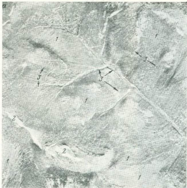
Фиг. 27. Проявление зон разломов в гидросети. Междуречье Еропол — Балаганчик. Анадырский сектор ОЧВП. Аэроснимок среднего масштаба и схема дешифрирования.
