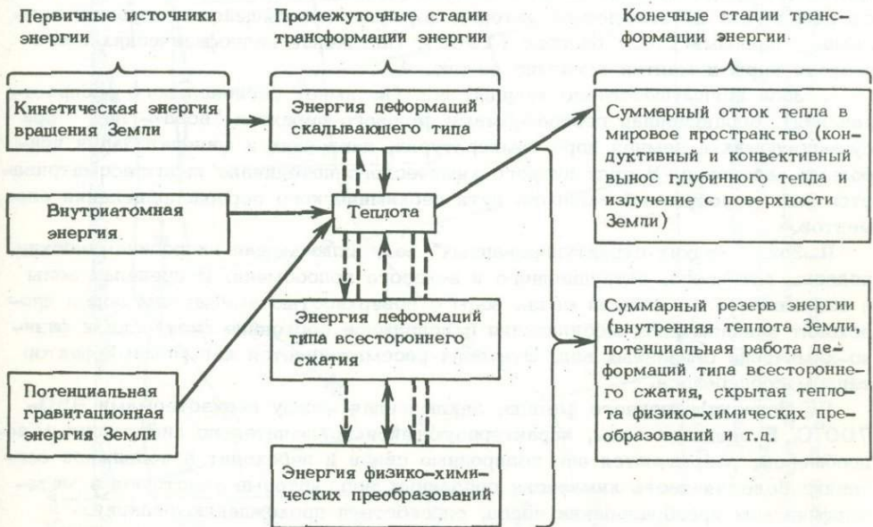
Общая схема энергетического баланса Земли (по Б.Г. Поляку, П.Н. Кропоткину, Ф.А. Макаренко, 1972)
