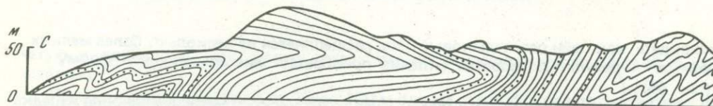
Р и с. 47. Сложная лежащая складка в карнийских алевролитах западного крыла Иньяли-Дебинского мегасинклинория на р. Индигирке (по А.Д. Чехову)
