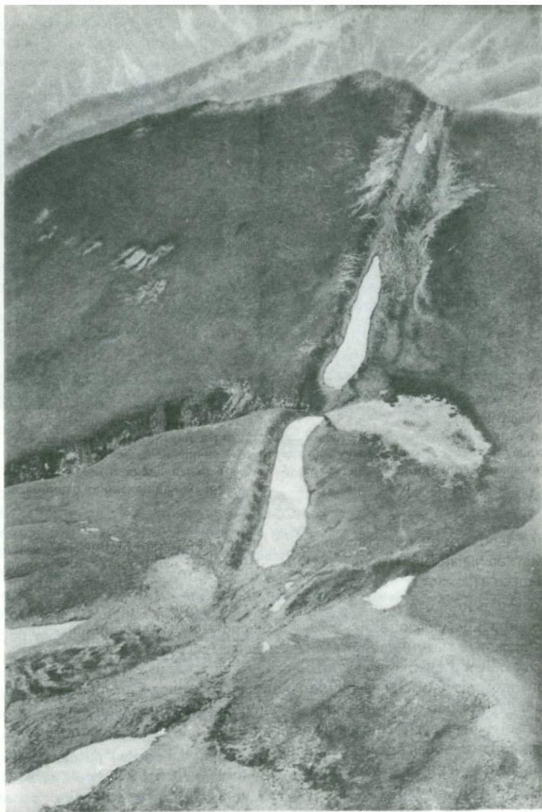
Р и с. 30. Район структуры Гоби. Сбросовый уступ пересекает кар в верховьях долины р. Цхенис-Цкали и уходит за водораздел. Сброс подчеркнут снежниками. Светлое пятно правее снежников в центре снимка — дно спущенного озера, возникшего за счет подпруживания водотока поднятым крылом сброса, на простирации которого находятся тыловые трещины отрыва оползней структуры Гоби. Фото В. Солоненко
