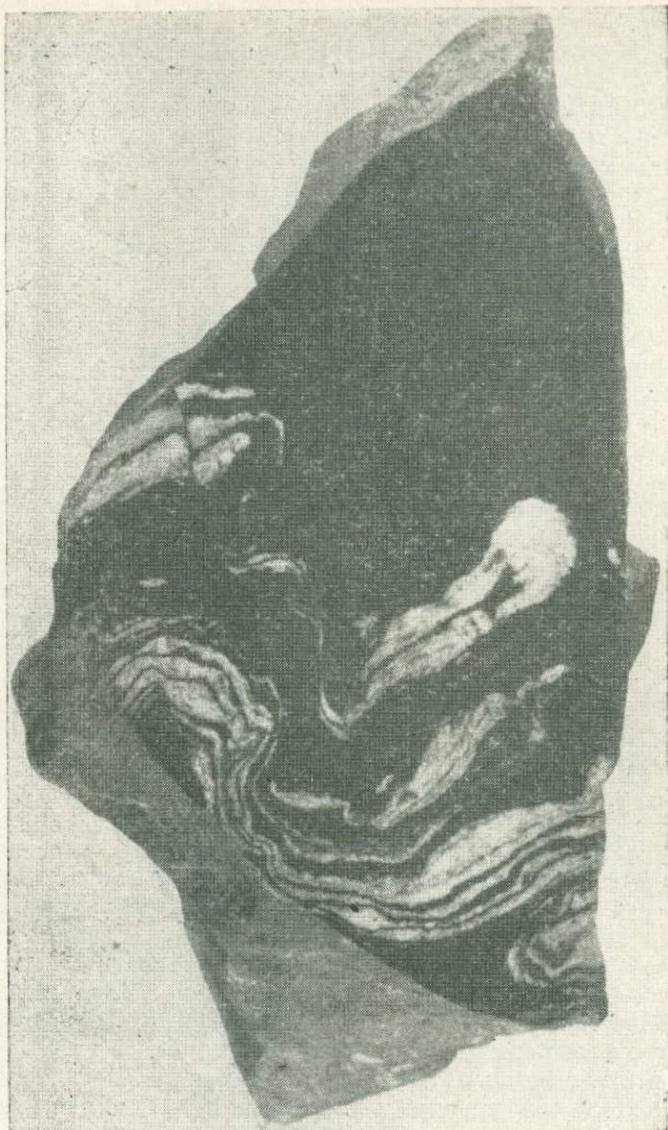
Рис. 3. Сложно деформированные обособления гранитного материала (белое) во вкрапленной кварц-роговообманково-магнетитовой руде. Штуф. Нат. вел.
