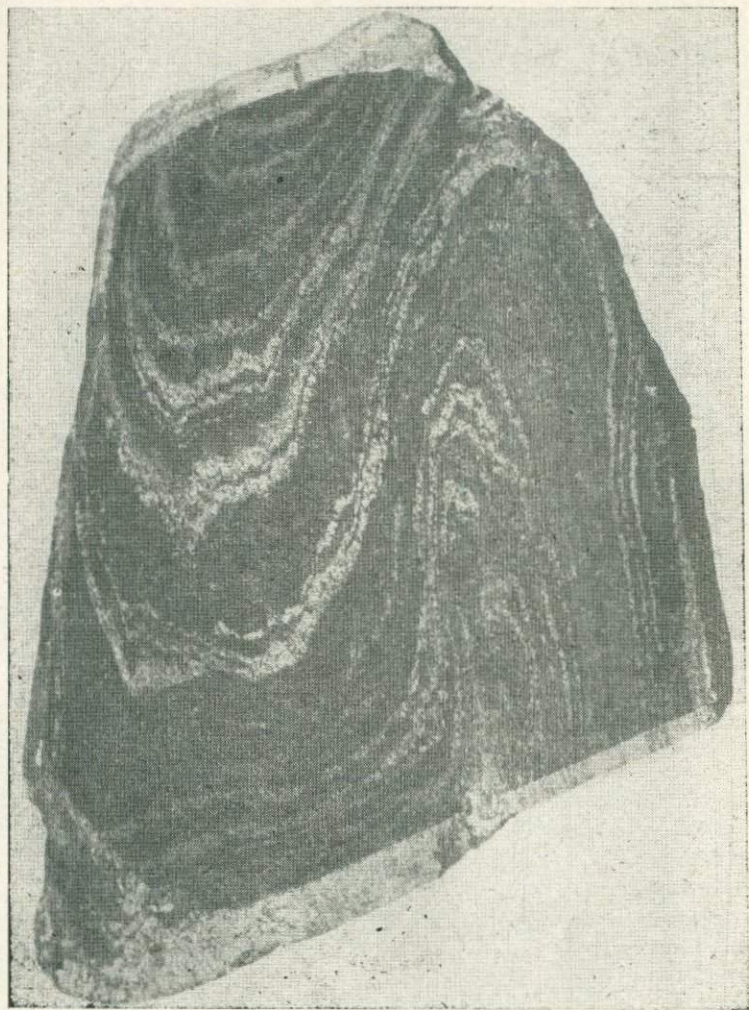
Рис. 2. Плойчатая текстура куммингтонит-кварц-магнетитовой руды. Светлое — полосы магнетита, темное — кварца. Штуф. Нат. вел.
