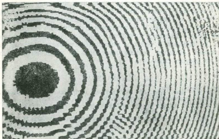
Рис. 5. Интерполированная бинарная голограмма точки.
