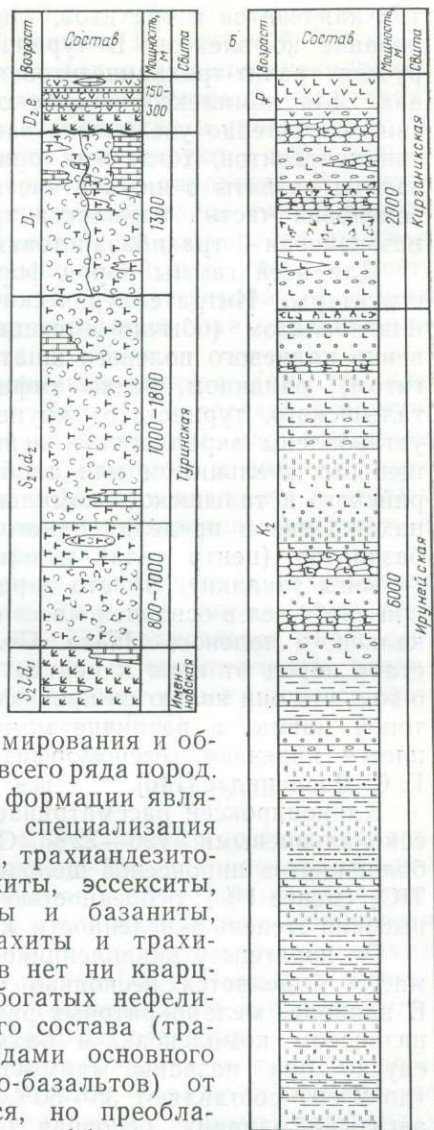
Рис. 37. Разрезы комплексов калиевых базальтов—трахитов: а — туринской, б — ирунейской и кирганикской свит.
