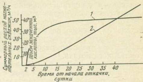
Рис. 65. График расхода нагнетательных скважин, при котором исключаются потери за контур.
