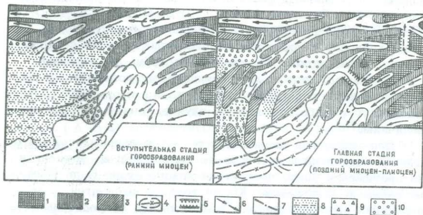
Рис. 40. Реконструкции главных путей переноса осадков в неогене (по Н. П. Костенко, 1970, фиг. 83 и 84, фрагмент). Области денудации: 1 — до 3000 м, 2 — низкорогорье, 3 — возвышенные равнины и плато, 4 — погребенные поднятия, 5 — сквозные долины, 6 — пути переноса осадков. Области аккумуляции: 7 — граница древней алувиальной равнины р. Амударья, 8 — пески, глины, 9 — брекчии, 10 — конгломераты.
