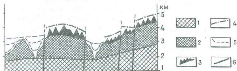
Рис. 39. Основные элементы эрозионно-денудационного расчленения горных хребтов (по Н. П. Костенко, 1972, фиг. 46). 1 - горный массив, не затронутый процессами денудации; 2 - зона линейной денудации; 3 - зона плоскостной денудации и эмбриональных безрусловых потоков в верховьях рек; 4 - реконструкция предороженной поверхности выравнивания; 5 - основные врезы; 6 - разрывы.
