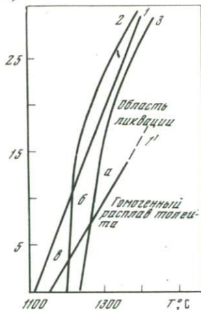
Рис. 53. P - T диаграмма образования и эволюции щелочных оливиновых базальтов до оливиновых нефелинитов и нефелинитов 1 — ликвидус оливинового толеита, по данным [22]; 1' — граница области ликвации—гомогенное состояние по данным [146]; 2 — ликвидус оливинового нефелинита, по данным [149]; 3 — ликвидус щелочного оливинового базальта по данным [28]. В области ликвации: а — условия образования щелочных оливиновых базальтов; б — условия образования оливиновых нефелинитов; в — условия образования нефелинитов
