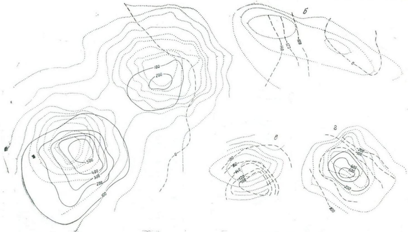
Рис. 2. Схема соотношений рельефа подводных гор «а», «б», «в», «г» и аномального поля \Delta T_n над ними. Изобаты показаны точками. Оцифровка изодинам — в гаммах
