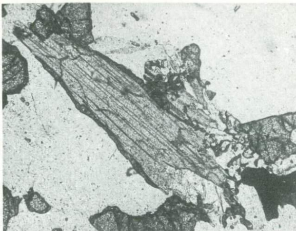
Рис. 77. Гиперстеновая реакционная каемка вокруг биотита в его контактах с плагиоклазом. В правой части шлифа – эмбриональная кордиерит-гиперстеновая кайма вокруг граната
