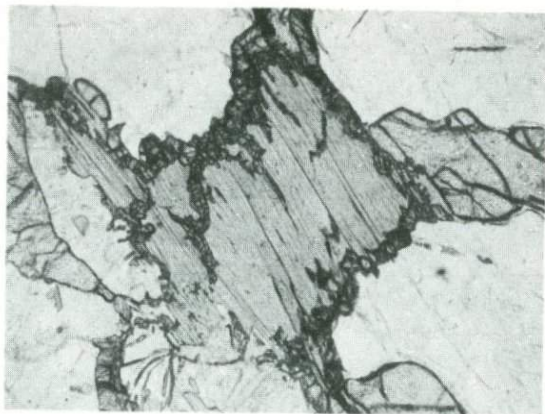
Рис. 75. Замещение биотита, находящегося в окружении кварца, каймой из мелких зерен гиперстена. В этом же образце широко развиты кордиерит-гиперстеновые каймы вокруг граната (см. рис. 81)
