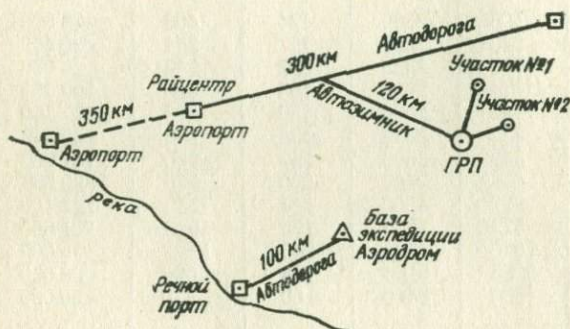
Рис. 3. Схема транспортных связей геологоразведочной экспедиции, работающей в Восточной Сибири
