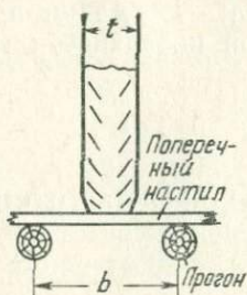
Рис. 29. Схема к расчету поперечного настила
