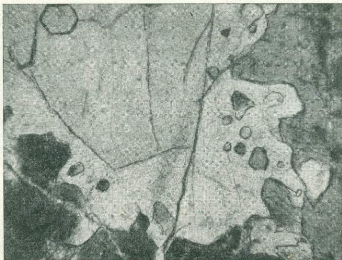
Рис. 86. Апатито-нефелиновая порода. Крупное зерно содалита с включениями апатита в краевой части. Шлиф, без анализатора, увел. 40.
