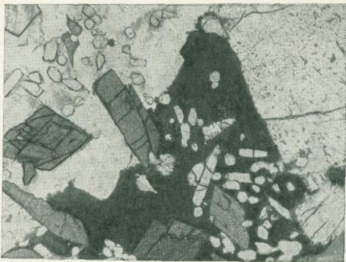
Рис. 74. Энигматит (черное) с включениями апатита (светлое) и сфена (темно-серое). Энигматит располагается между полевым шпатом и нефелином. Сфеновый уртит, шлиф, без анализатора, увел. 10.
