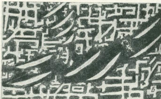
Рис. 66. Структуры распада твердого раствора титаномагнетита хибинских апатитовых месторождений (зарисовки с рисовальной насадкой РА-4).
