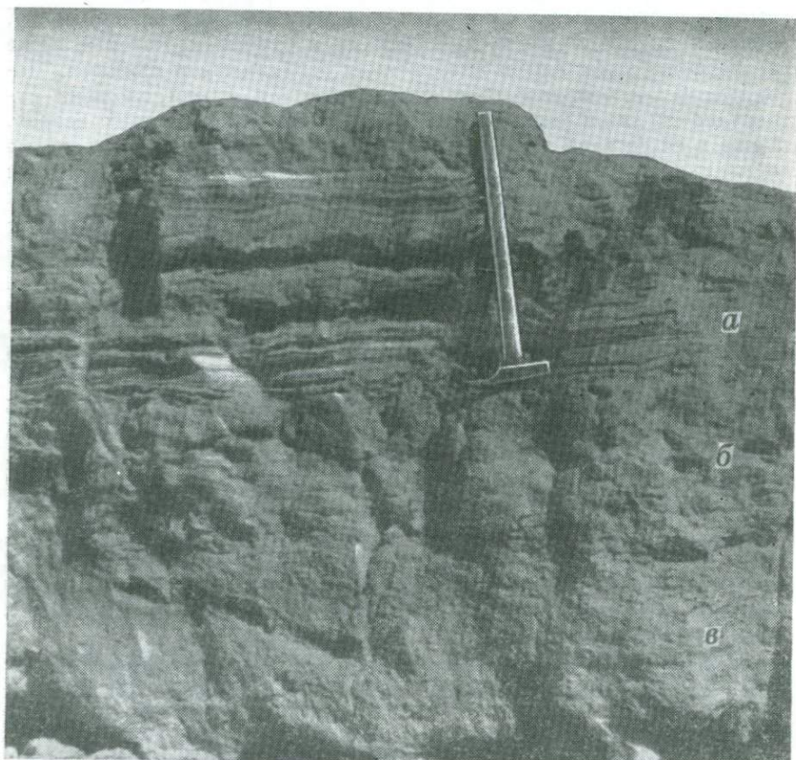
Рис. 14. Характер отложений субфации мелких временных застойных водоемов на сохском конусе выноса у сел. Беко-Бача (продольное сечение). а — пачка ритмичнослоистых глин; б — суглинки тяжелые; в — супеси легкие
