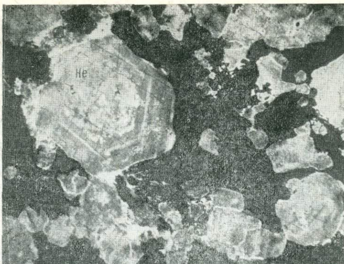
Ф и г. 17. Зоны роста в нефелине из ийолитов, массив Гремяха-Вырмес Увеличение 10, без анализатора
