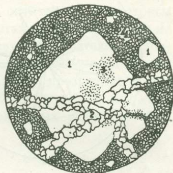
Фиг. 6. Вторичный кварцит из гранодиорит-порфира. Увеличено в 15 раз. Остаточный кварц-вкрапленник, разбитый жилками кварца; части вкрапленника не передвинуты — угасание одновременное. 1 — вкрапление кварца, 2 — жилки вторичного кварца, 3 — серицит и 4 — кварц с серицитом. (Скв. 130, глуб. 55—56 м.)
