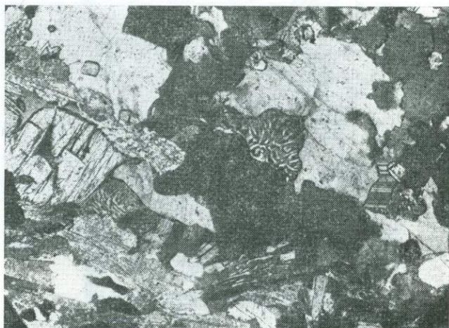
Рис. 18. Симплектитовые сростания биотита и кварца и микроклинита кварца в биотит-гиперстен-кордиеритовом гнейсе, шлиф 3521/27, \times 70 , николи скрещены
