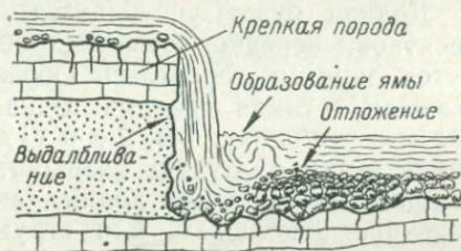
Рис. 52. Водопад — результат пятающейся эрозии.
