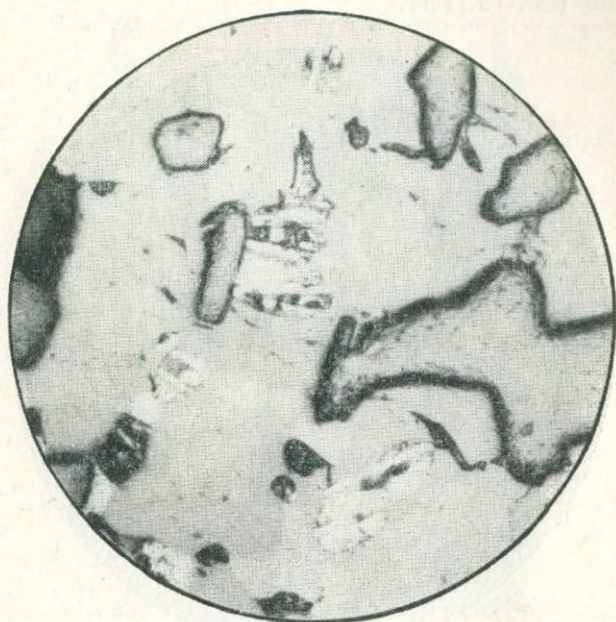
Рис. 21. Титаномагнетит в базальте Берестовецкого карьера (Ровенская обл.). Структура распада твердого раствора выявлена травлением \text{HCl} . Белый — ильменит, пестрый, травленный — магнетит. Аншлиф 145, \times 300 .
