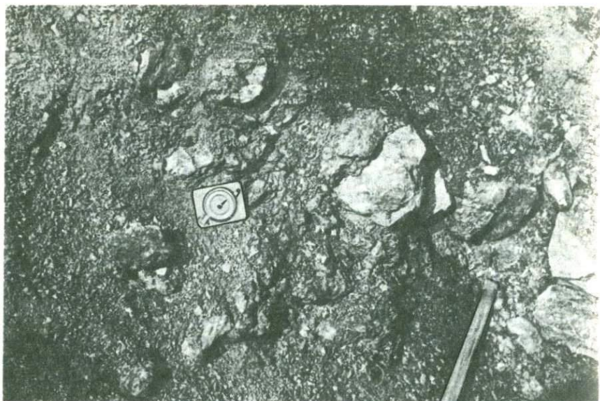
Рис. 29. Базальный горизонт вулканогенно-кремнистых отложений верхнего палеозоя. Гиалокластиты цементируют обломки, гальку и валуны габбро, гипербазитов, кремней. Гора Эконай
