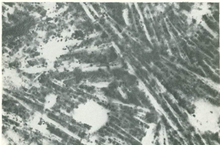
Фиг. 1-5. Обильные округленные капли камасита в шлифе брекчи 14 068,7. Снимок НАСА, S-71-40812.
