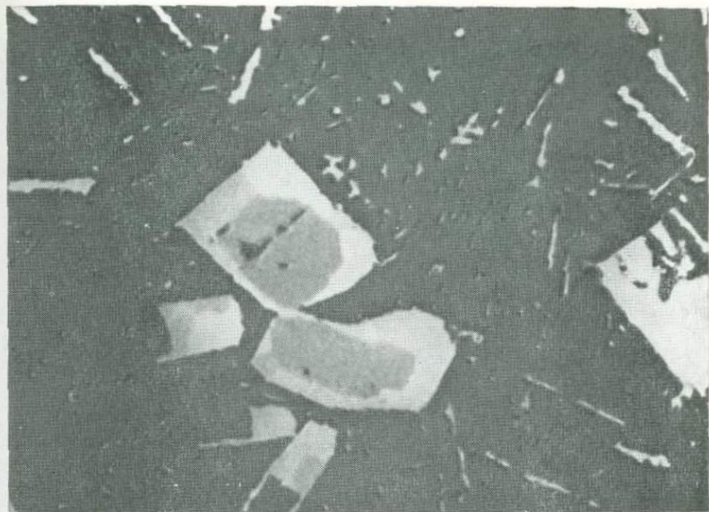
Фиг. 5-3. Армоколлит (темно-серые ядра), частично замещенный пльменитом (более светло-серое). В масляной иммерсии. \times 725 . Suppl. 1, 234.
