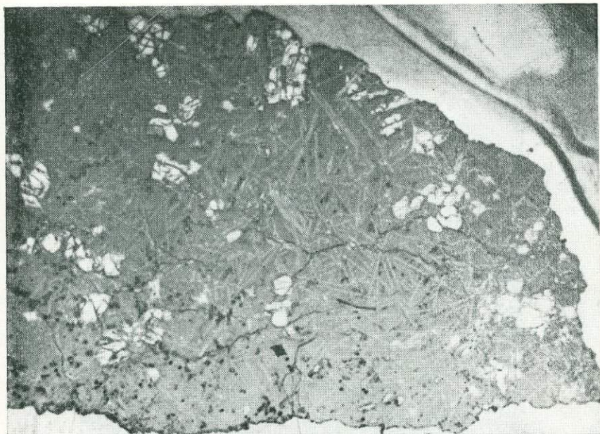
Фиг. 10-3. Фенокристаллы оливина (светло-серые) и плагиоклаза (удлинённо-серые) в порфировом оливиновом базальте 12 009. Снимок НАСА, S-70-25427.
