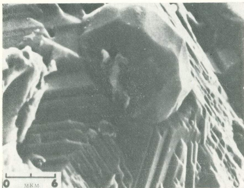
Фиг. 2-8. Кристалл шрейберзита на ступенях роста металлического железа. Suppl. 4, 325.
