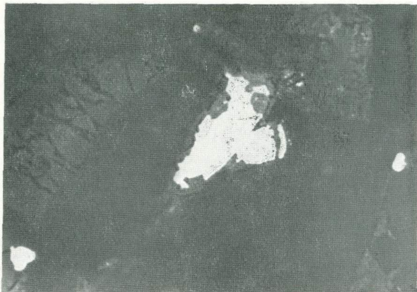
Фиг. 3-9. Красная «гётитовая» кайма (на фото светло-серое), обрамляющая зерно камасита (белое). Полированный шлиф в отраженном свете. × 1500. Bull. Soc. Min. 96, 364.
