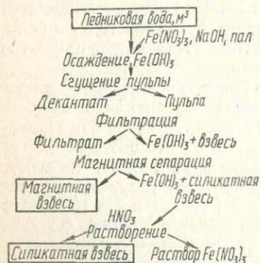
Рис. 20. Технологическая схема выделения взвесей и гидролизующихся элементов из талой ледниковой воды ледника Гарабаши.
