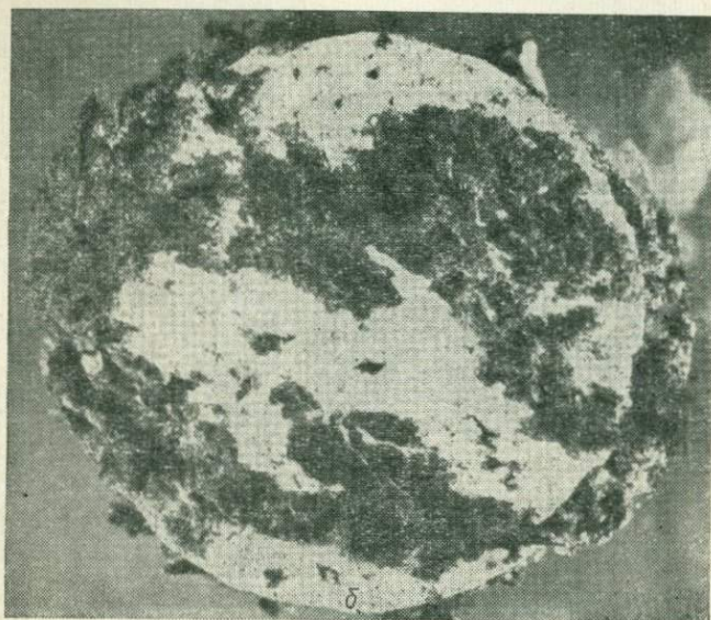
Рис. 9. Кривая распределения среднего размера диаметров пор d_{\text{ср.пор}} образцов (а) и образец доломита, прокрашенный метилметакрилатом и частично растворенный в соляной-кислоте (б)
