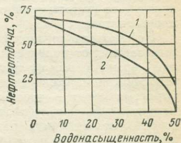
Рис. 1.3. Зависимость нефтеотдачи при прохождении фронта вытеснения от вязкости нефти
