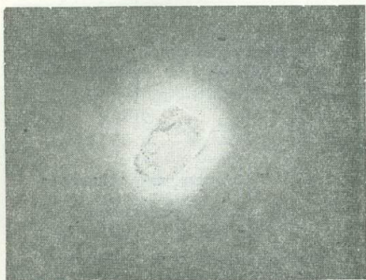
Рис. 97. Действие на фотопластинку уранинита из жилы «Хитаостров». Уранинит лежал на грани куба — темные места соответствуют остаткам карбоцера. (Экспозиция 3 суток.)
