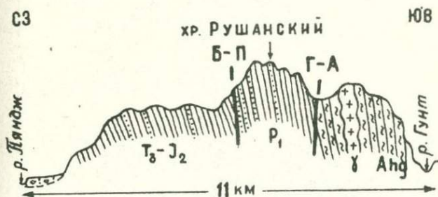
Рис. 4. Геологический разрез Рушанского хребта по правому склону долины р. Пяндж. Г-А- Гунт-Аличурский разлом; Б-П - Бартанг-Пшартский разлом.
