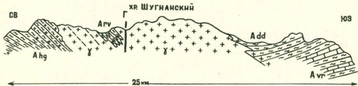
Рис. 3. Геологический разрез Шугнанского хребта по долине р. Багывдара (бассейн р. Шахдара). Г - Гармчашминский разлом.
