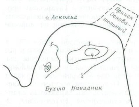
Рис. 31. Схема естественной радиоактивности (в усл. ед.) донных грунтов бухты Наездник (о. Аскольд)
