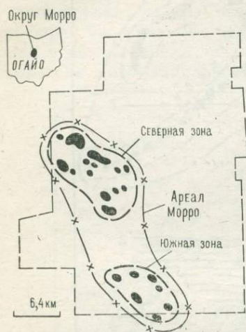
Рис. 38. Ареал Морро (США, Огайо), объединяющий зоны нефтегазонакопления, связанные с региональным параллельным несогласием и заключающие месторождения погребенных возвышенностей палеорельефа.
