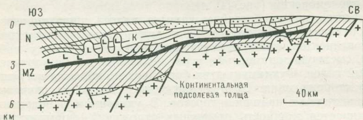
Рис. 51. Геологический разрез (Буйо, 1971) Кванза-Камерунского нефтегазозносного бассейна в периконтинентальном полуграбене
