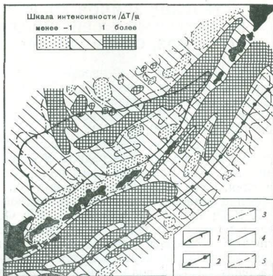
Рис. 32. Карта аномального магнитного поля ( \Delta T ) (по М. Л. Красному, схематизировано)
