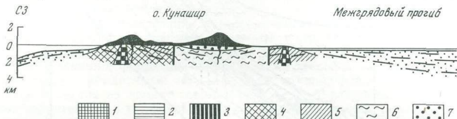
Рис. 46. Обобщенный геологический разрез через Курильское островное поднятие (на широте о-вов Кунашир, Шикотан)
