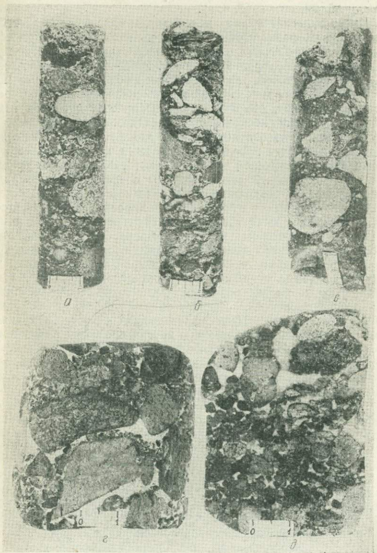
Рис. 6. Керн вулканических туфов из скв. Борщевская Р1. Туфы мелкоагломератовой структуры в основном щелочно-трахитового состава; гл. 2244—2248 м (а), 2146—2147 м (б), 2167—2177 м (в, в) и 2052—2058 м (д)
